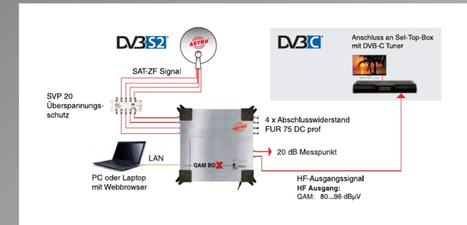
Zwei QAM BOX eco Module kaskadiert mit Anschluss an ein TV-Gerät mit DVB-C Tuner
